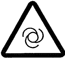
Kompressori on kaukokäynnisteinen, käynnistyy automaattisesti
